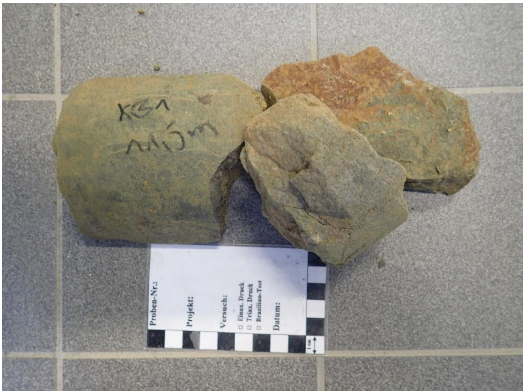
Abbildung 7: Probe KB1 (11,5 m) bei Anlieferung.
