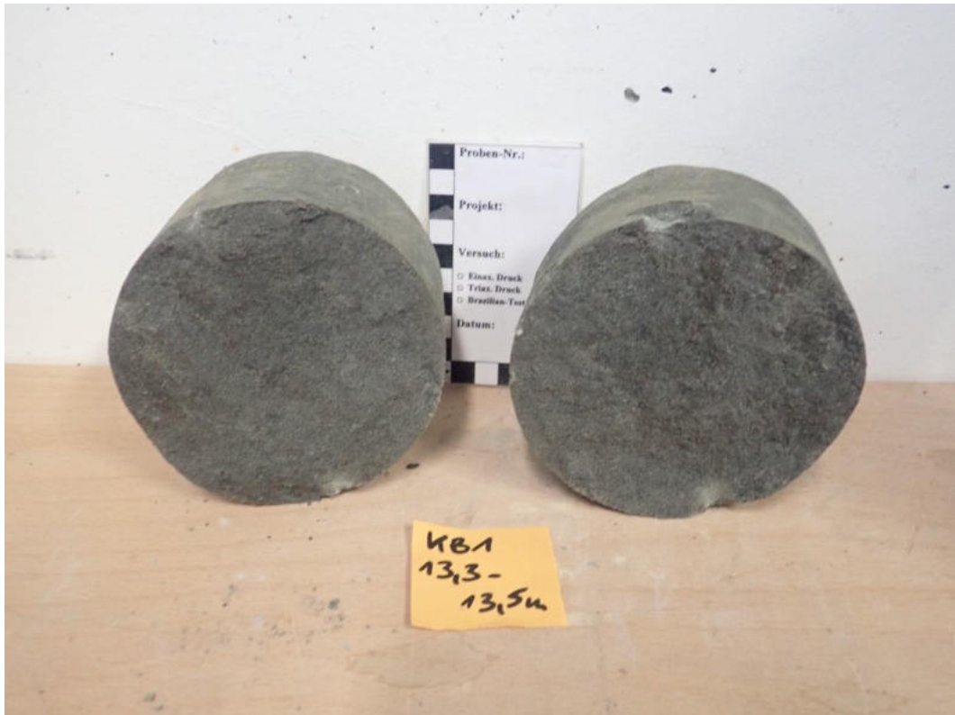
Abbildung 35: Punktlastversuch Probe KB1 (13,3 – 13,5 m): Probe Versuch 2.
