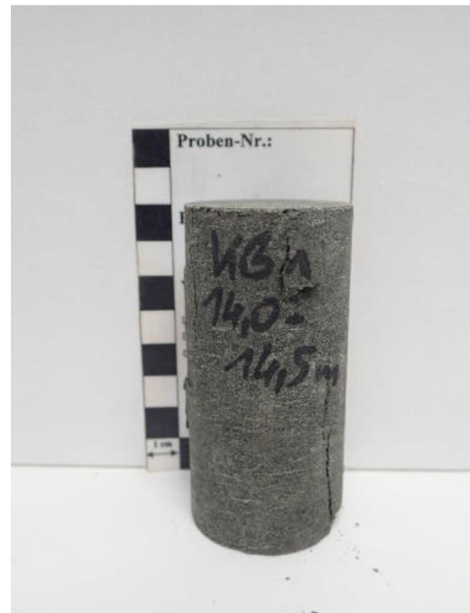
Abbildung 24: Einaxialer Druckversuch Probe KB1 (14,0 – 14,5 m): Spannungs-Dehnungs-Linie, Probe vor dem Versuch, Probe nach dem Versuch.
