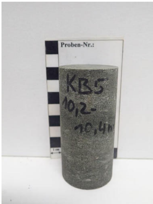
Abbildung 30: Einaxialer Druckversuch Probe KB5 (10,2 – 10,4 m): Spannungs-Dehnungs-Linie, Probe vor dem Versuch, Probe nach dem Versuch.
