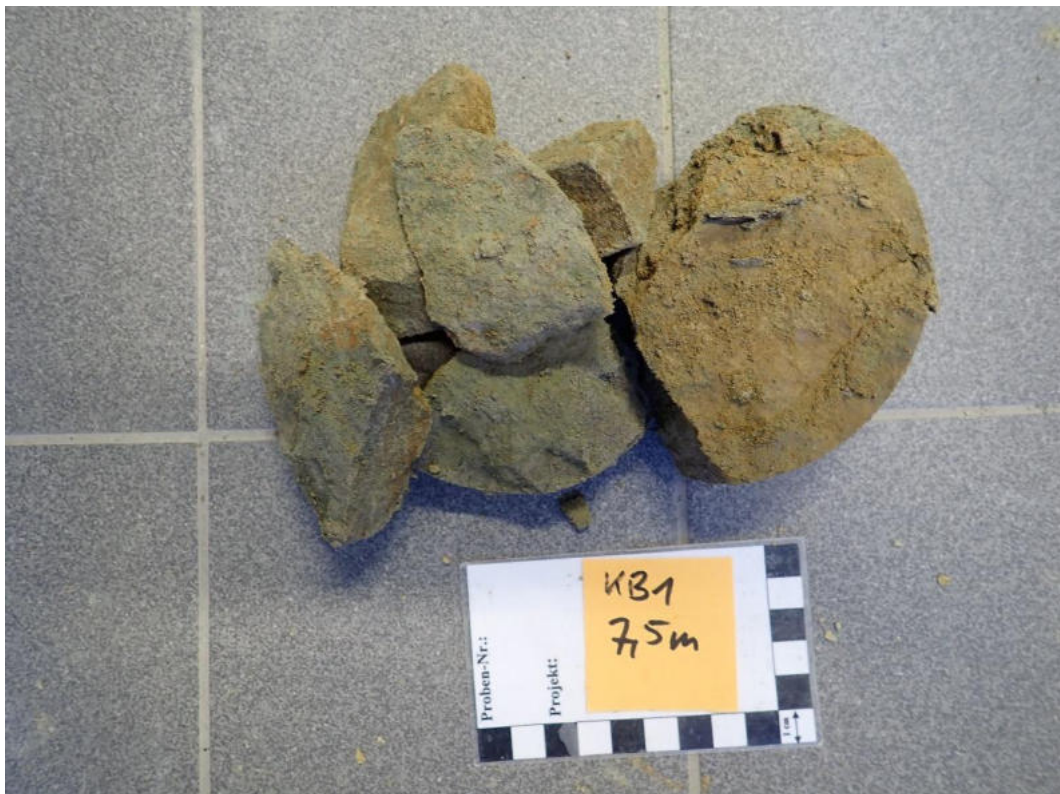
Abbildung 3: Probe KB1 (7,5 m) bei Anlieferung.
