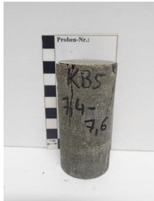
Abbildung 28: Einaxialer Druckversuch Probe KB5 (7,4 – 7,6 m): Spannungs-Dehnungs-Linie, Probe vor dem Versuch, Probe nach dem Versuch.
