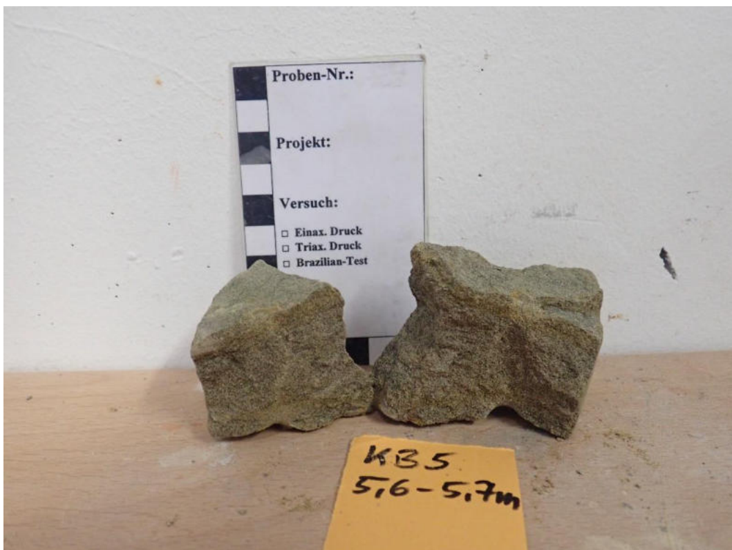
Abbildung 47: Punktlastversuch Probe KB5 (5,6 – 5,7 m): Probe Versuch 3.
