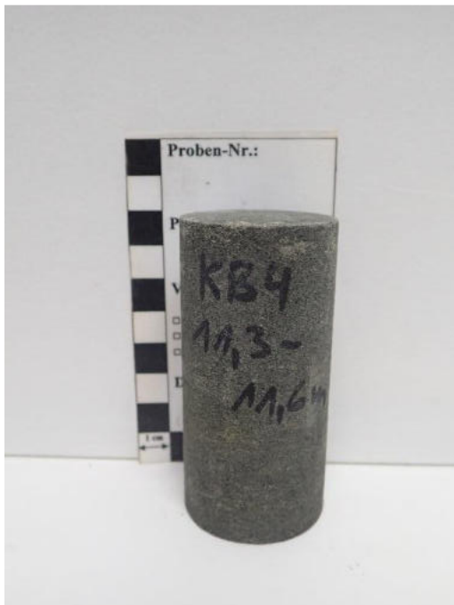
Abbildung 26: Einaxialer Druckversuch Probe KB4 (11,3 – 11,6 m): Spannungs-Dehnungs-Linie, Probe vor dem Versuch, Probe nach dem Versuch.
