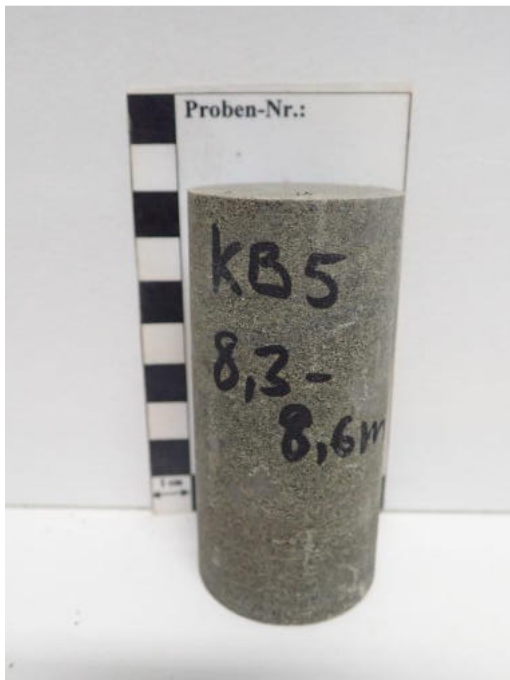
Abbildung 29: Einaxialer Druckversuch Probe KB5 (8,3 – 8,6 m): Spannungs-Dehnungs-Linie, Probe vor dem Versuch, Probe nach dem Versuch.
