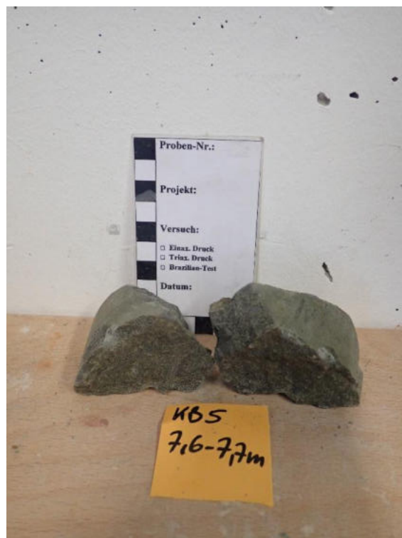
Abbildung 62: Punktlastversuch Probe KB5 (7,6 – 7,7 m): Probe Versuch 9.
