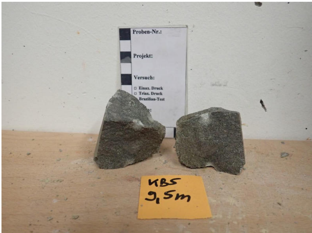
Abbildung 69: Punktlastversuch Probe KB5 (9,5 m): Probe Versuch 5.
