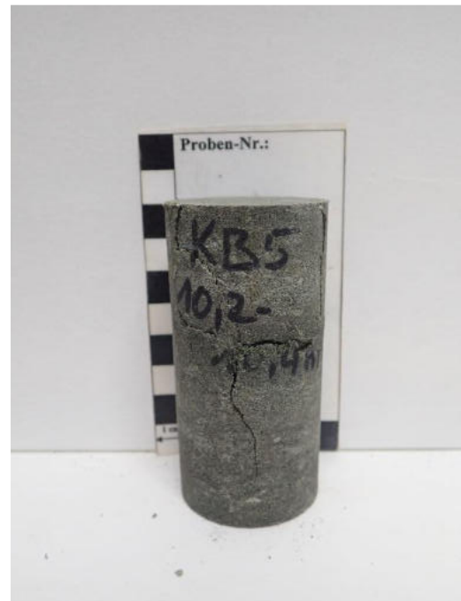
Abbildung 30: Einaxialer Druckversuch Probe KB5 (10,2 – 10,4 m): Spannungs-Dehnungs-Linie, Probe vor dem Versuch, Probe nach dem Versuch.
