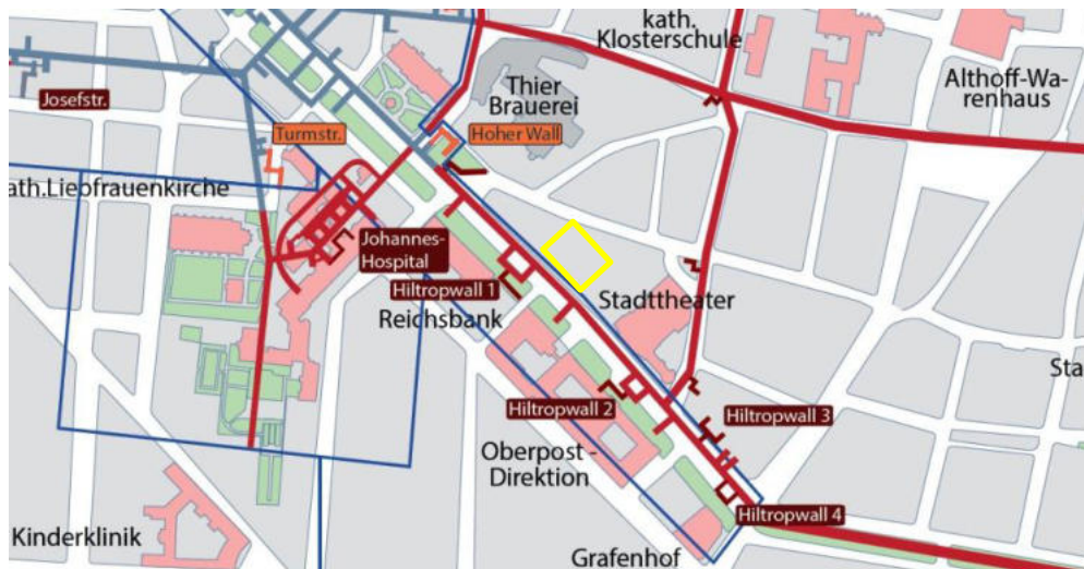
Abbildung 12: Auszug des Lageplans zum Luftschutzstollen mit Darstellung fertiggestellter Bereiche (blau) und geplanter Bereiche (rot) aus /18/ mit grober Eintragung des Projektareals (gelb)
