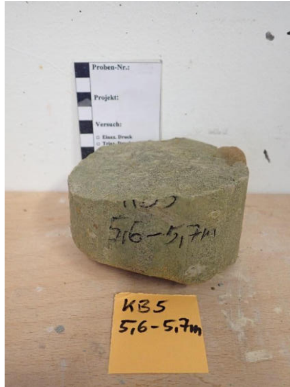
Abbildung 44: Punktlastversuch Probe KB5 (5,6 – 5,7 m): Probe vor dem Versuch.
