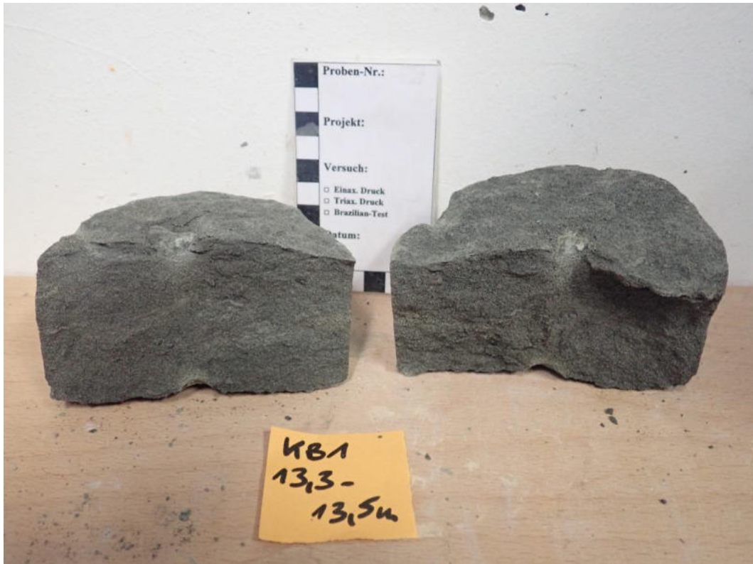
Abbildung 37: Punktlastversuch Probe KB1 (13,3 – 13,5 m): Probe Versuch 4.
