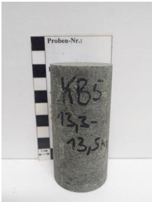
Abbildung 31: Einaxialer Druckversuch Probe KB5 (13,3 – 13,5 m): Spannungs-Dehnungs-Linie, Probe vor dem Versuch, Probe nach dem Versuch.
