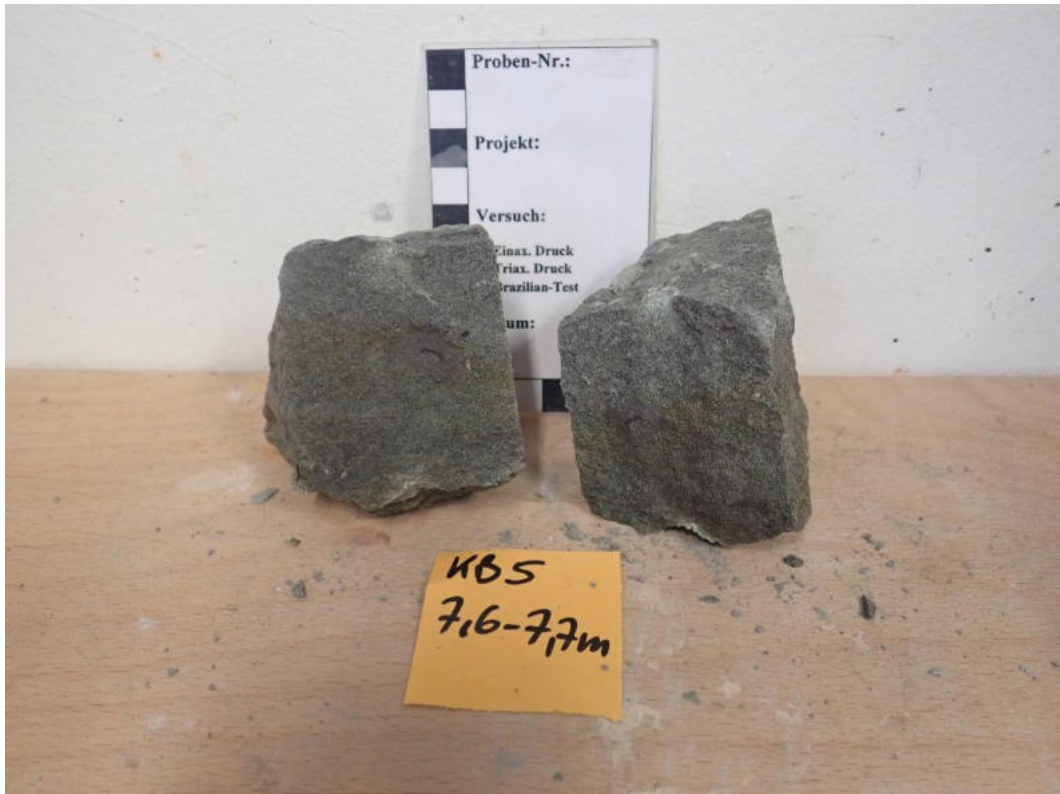
Abbildung 59: Punktlastversuch Probe KB5 (7,6 – 7,7 m): Probe Versuch 6.
