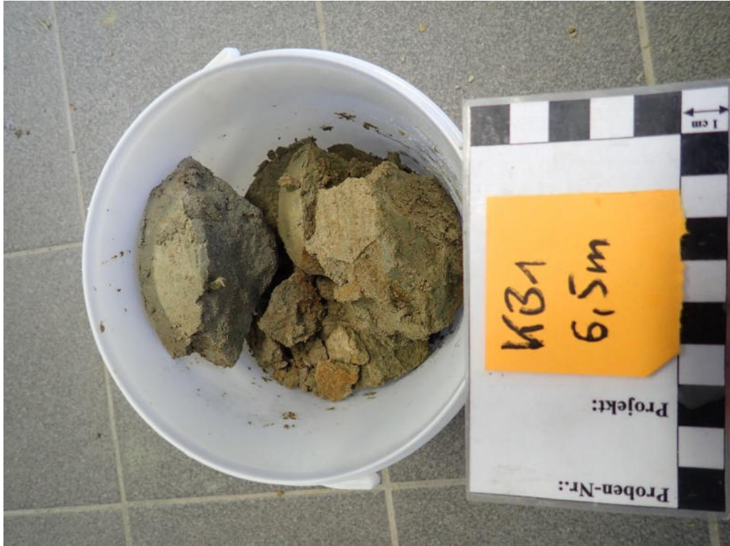
Abbildung 2: Probe KB1 (6,5 m) bei Anlieferung.
