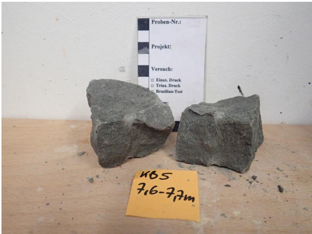
Abbildung 58: Punktlastversuch Probe KB5 (7,6 – 7,7 m): Probe Versuch 5.
