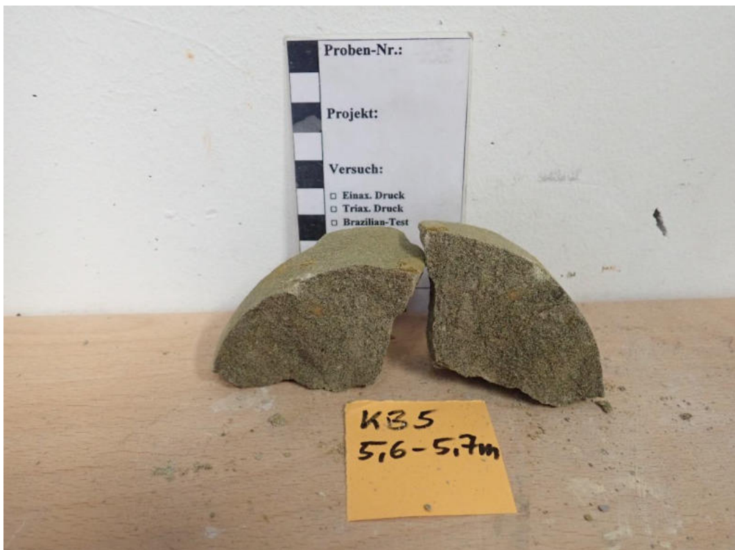
Abbildung 51: Punktlastversuch Probe KB5 (5,6 – 5,7 m): Probe Versuch 7.
