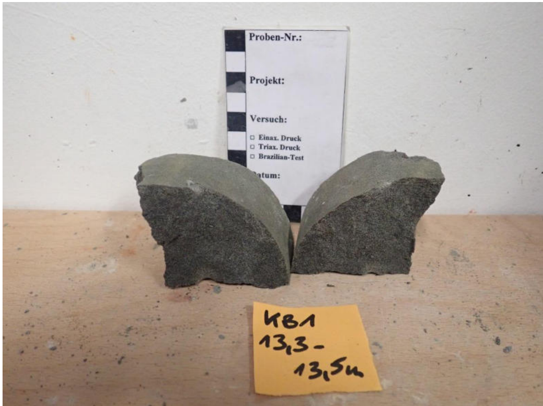
Abbildung 41: Punktlastversuch Probe KB1 (13,3 – 13,5 m): Probe Versuch 8.
