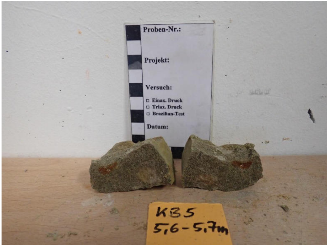
Abbildung 52: Punktlastversuch Probe KB5 (5,6 – 5,7 m): Probe Versuch 8.
