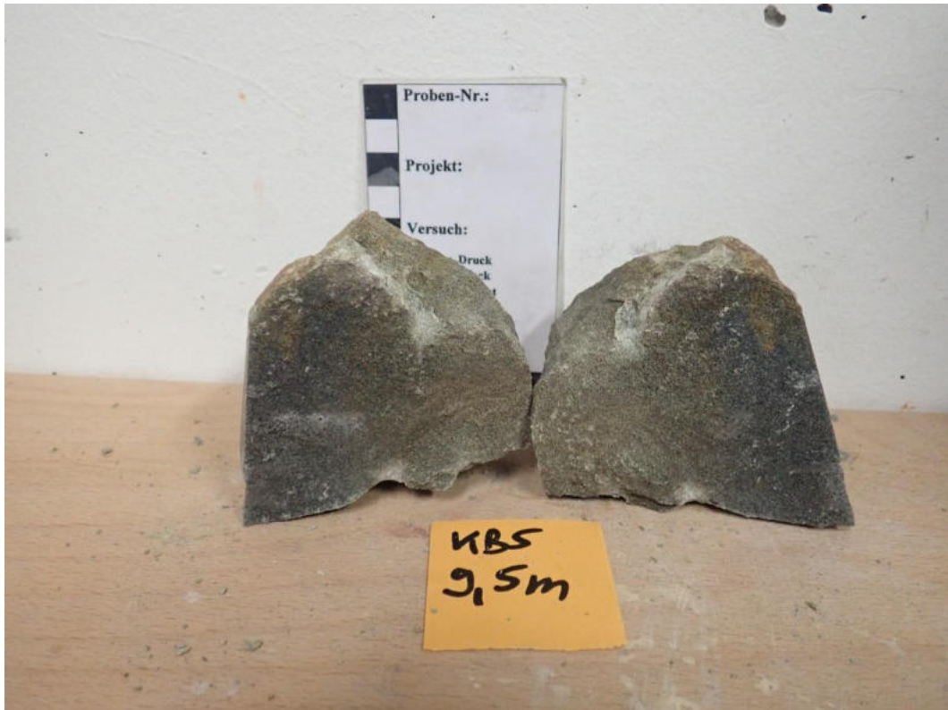
Abbildung 70: Punktlastversuch Probe KB5 (9,5 m): Probe Versuch 6.
