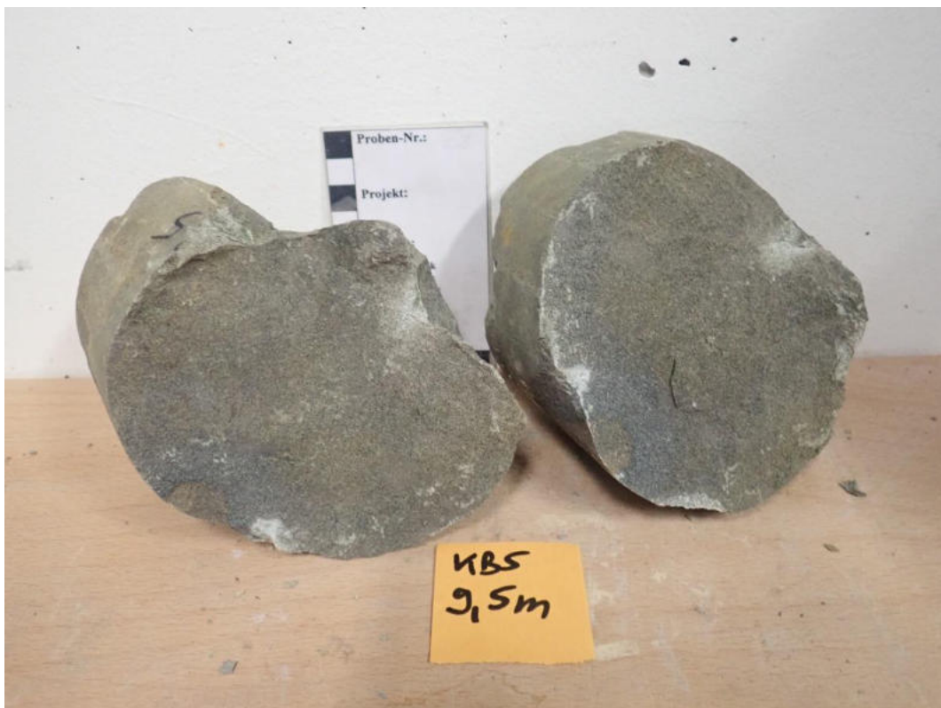
Abbildung 65: Punktlastversuch Probe KB5 (9,5 m): Probe Versuch 1.
