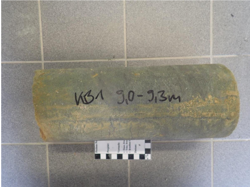
Abbildung 6: Probe KB1 (9,0 – 9,3 m) bei Anlieferung.
