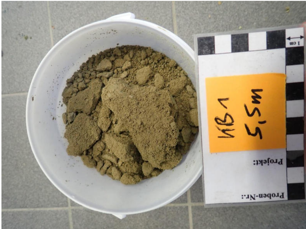
Abbildung 1: Probe KB1 (5,5 m) bei Anlieferung.
