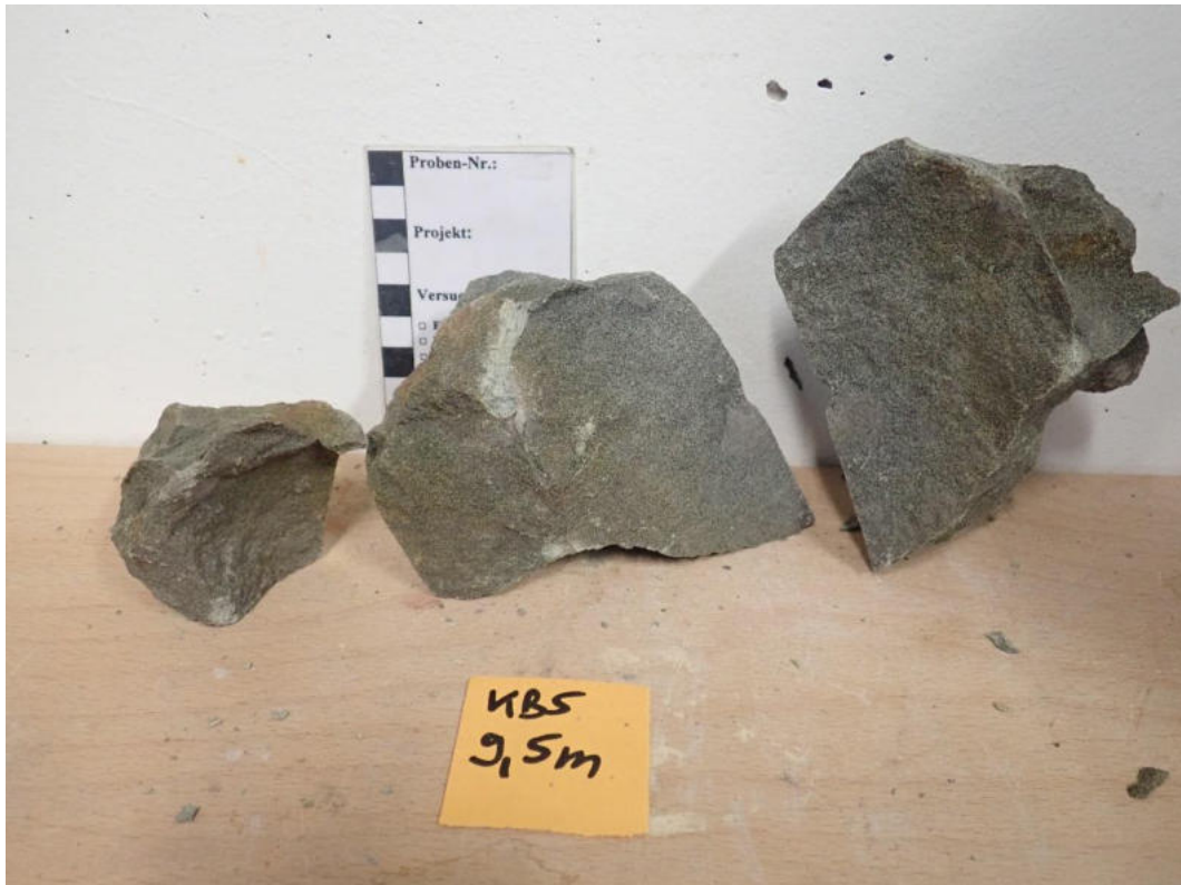
Abbildung 66: Punktlastversuch Probe KB5 (9,5 m): Probe Versuch 2.
