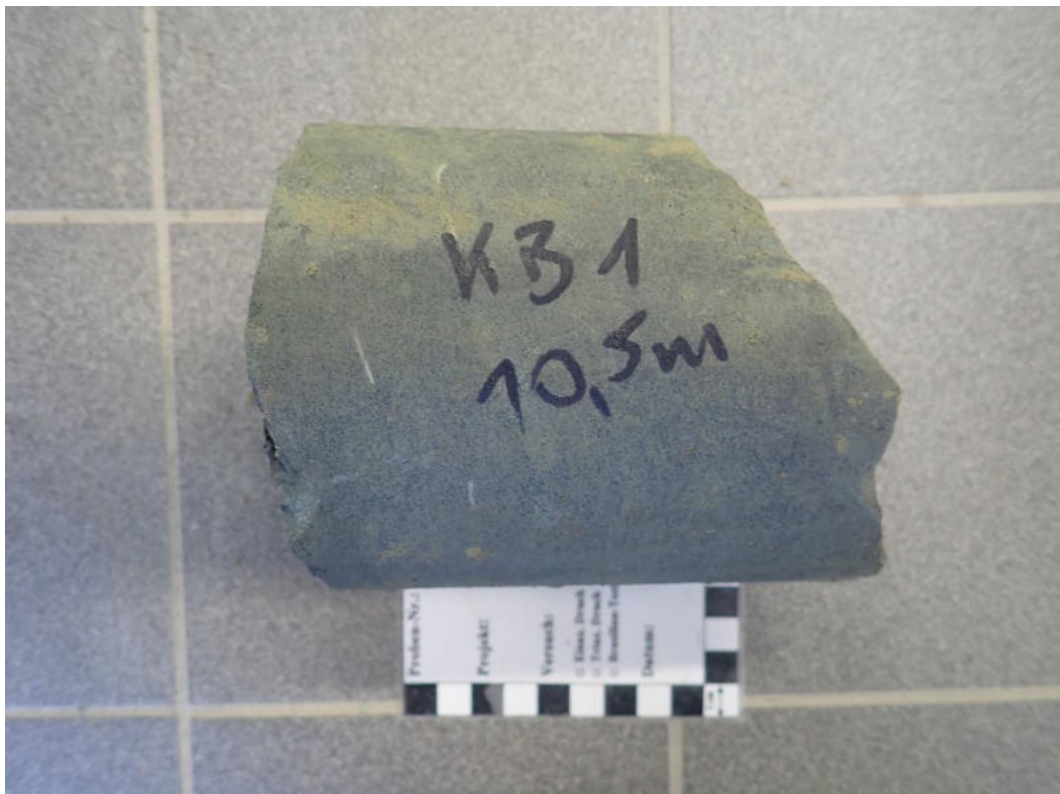
Abbildung 5: Probe KB1 (10,5 m) bei Anlieferung.
