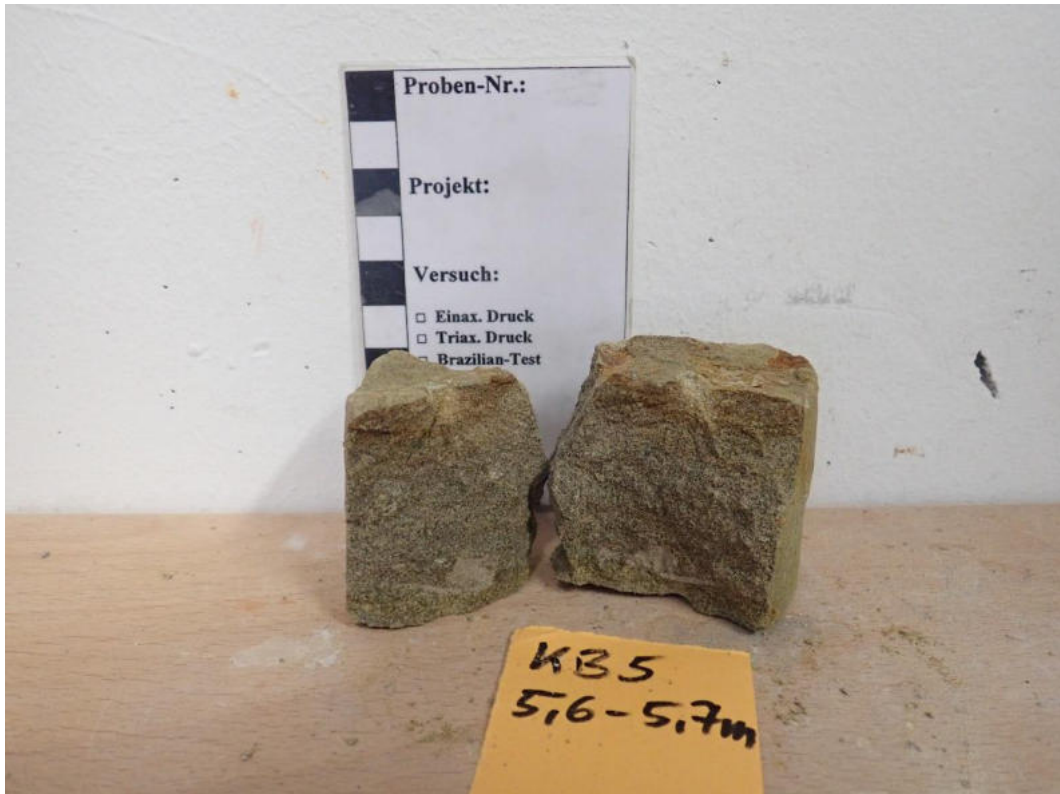
Abbildung 48: Punktlastversuch Probe KB5 (5,6 – 5,7 m): Probe Versuch 4.
