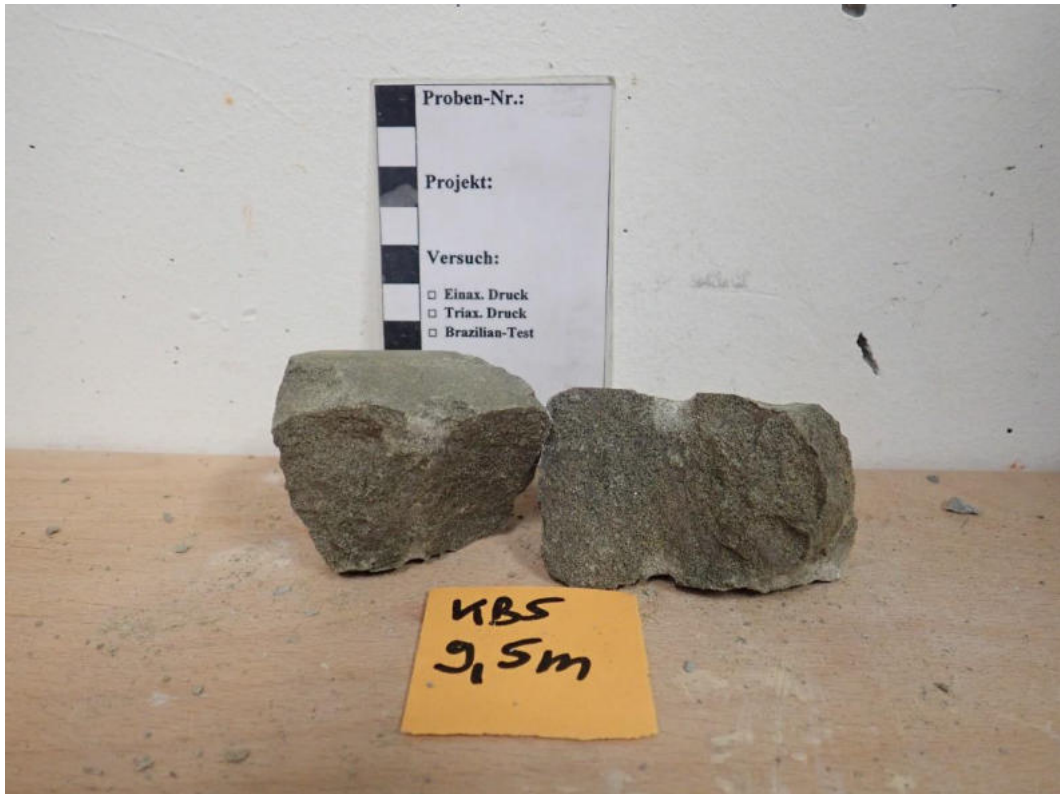
Abbildung 72: Punktlastversuch Probe KB5 (9,5 m): Probe Versuch 8.
