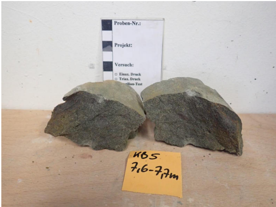
Abbildung 61: Punktlastversuch Probe KB5 (7,6 – 7,7 m): Probe Versuch 8.
