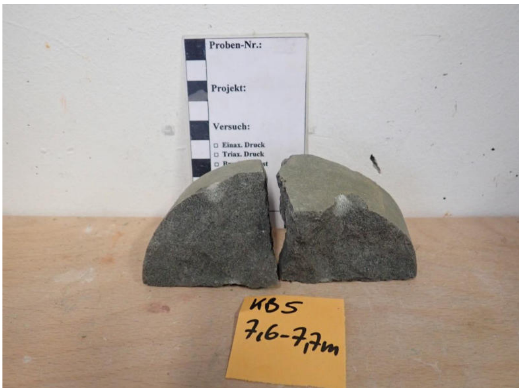
Abbildung 60: Punktlastversuch Probe KB5 (7,6 – 7,7 m): Probe Versuch 7.
