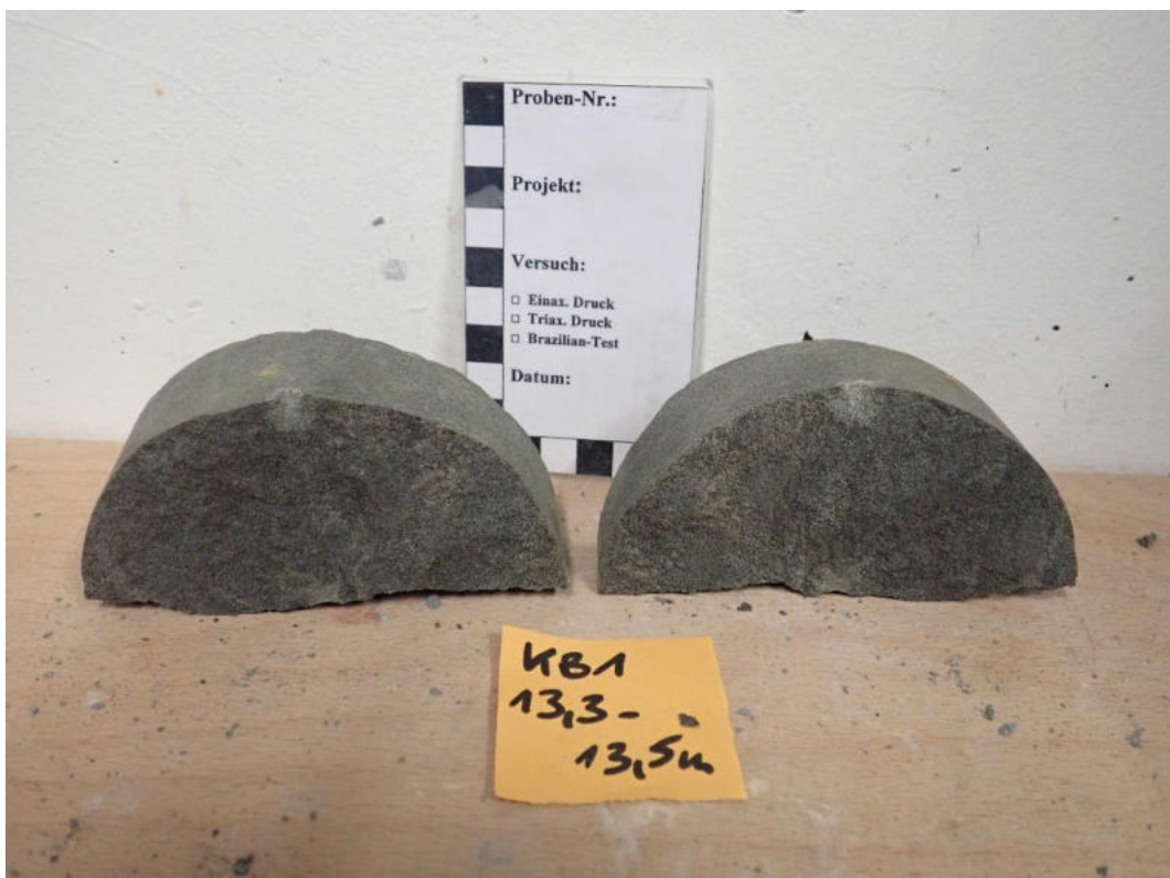
Abbildung 42: Punktlastversuch Probe KB1 (13,3 – 13,5 m): Probe Versuch 9.
