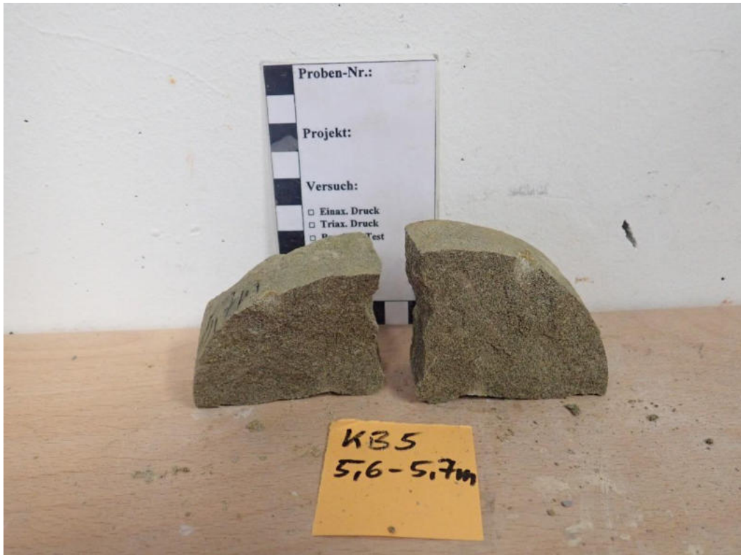
Abbildung 50: Punktlastversuch Probe KB5 (5,6 – 5,7 m): Probe Versuch 6.
