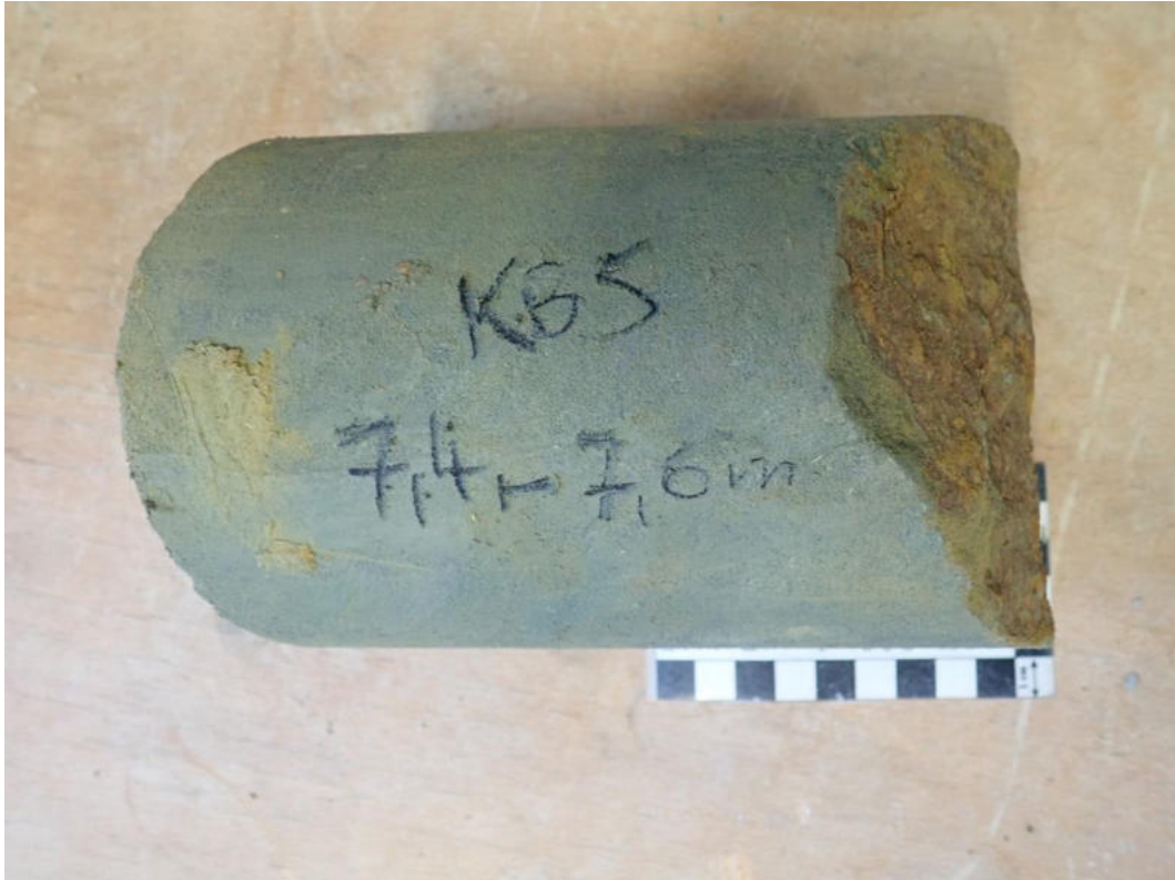
Abbildung 16: Probe KB5 (7,4 – 7,6 m) bei Anlieferung.
