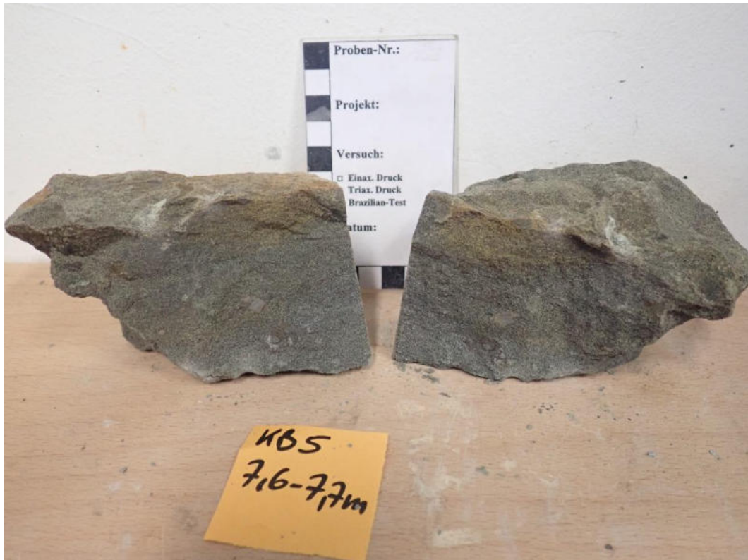
Abbildung 55: Punktlastversuch Probe KB5 (7,6 – 7,7 m): Probe Versuch 2.
