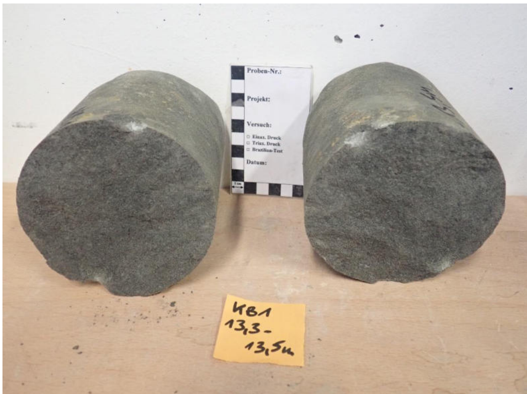
Abbildung 34: Punktlastversuch Probe KB1 (13,3 – 13,5 m): Probe Versuch 1.
