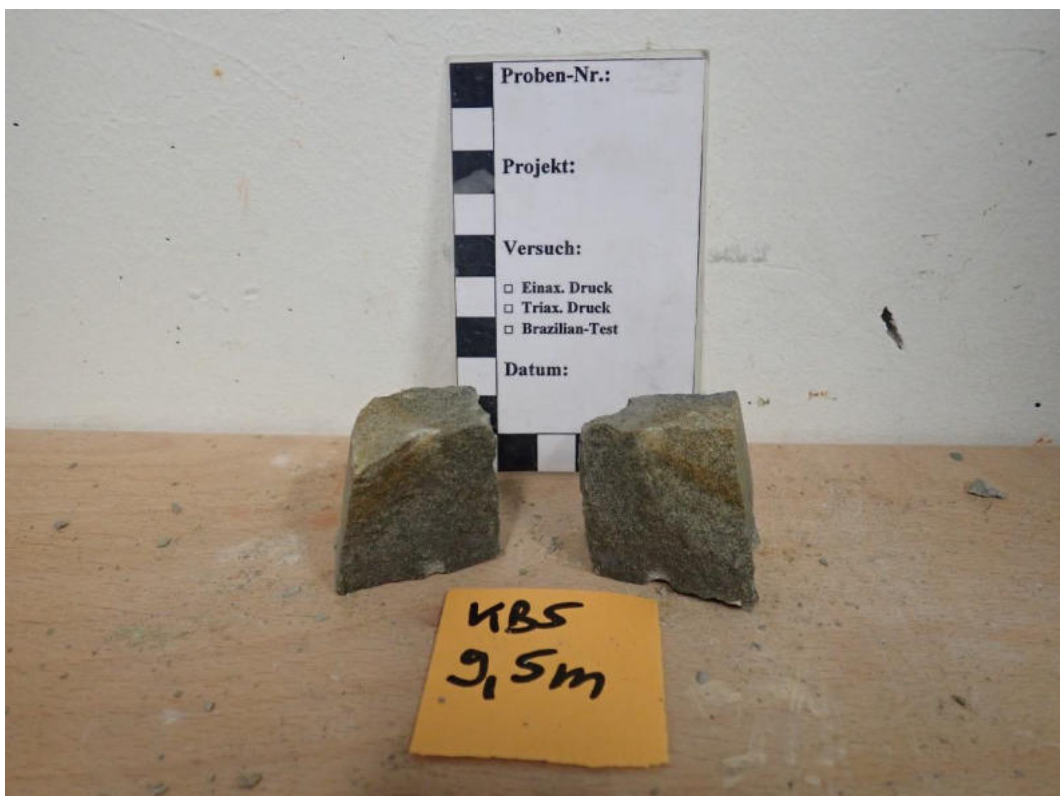
Abbildung 73: Punktlastversuch Probe KB5 (9,5 m): Probe Versuch 9.
