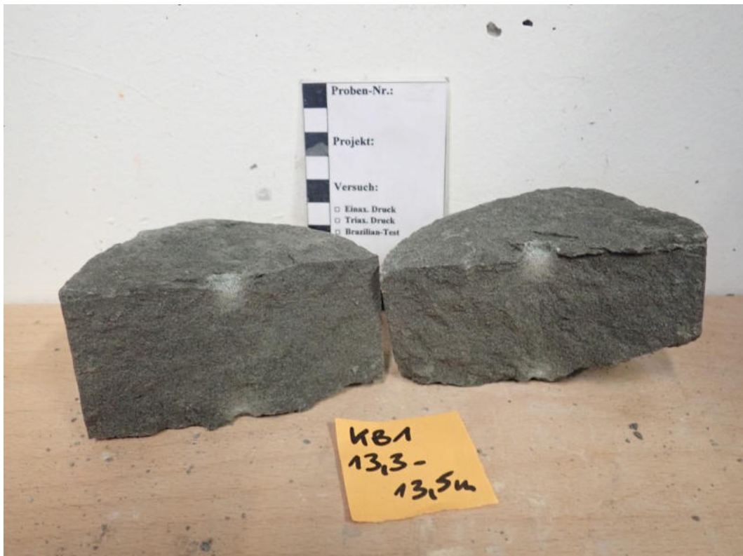
Abbildung 38: Punktlastversuch Probe KB1 (13,3 – 13,5 m): Probe Versuch 5.
