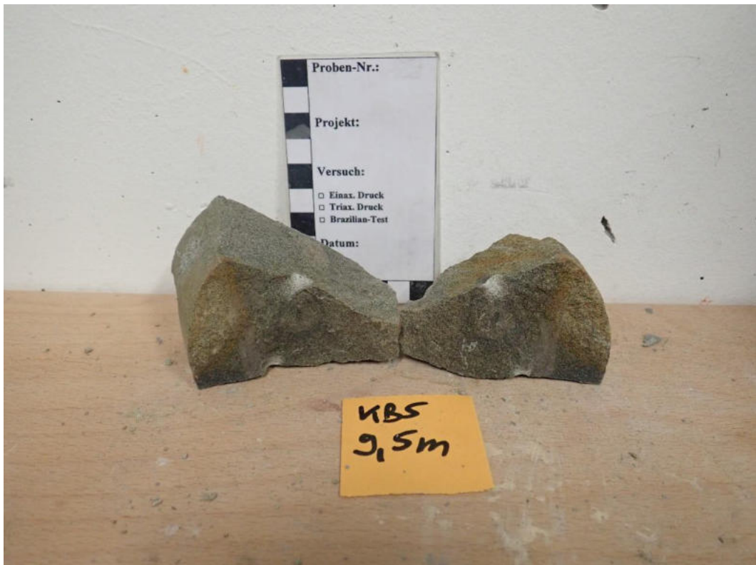
Abbildung 71: Punktlastversuch Probe KB5 (9,5 m): Probe Versuch 7.
