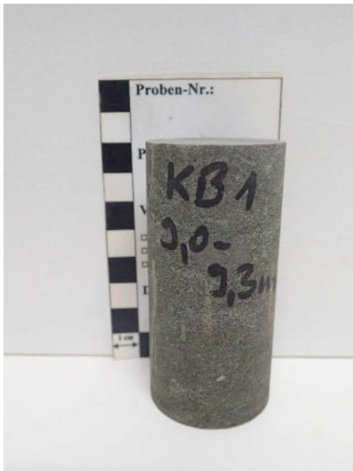
Abbildung 23: Einaxialer Druckversuch Probe KB1 (9,0 – 9,3 m): Spannungs-Dehnungs-Linie, Probe vor dem Versuch, Probe nach dem Versuch.
