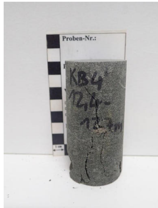
Abbildung 27: Einaxialer Druckversuch Probe KB4 (12,4 – 12,7 m): Spannungs-Dehnungs-Linie, Probe vor dem Versuch, Probe nach dem Versuch.
