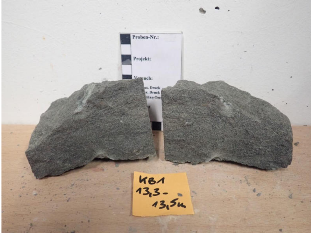
Abbildung 43: Punktlastversuch Probe KB1 (13,3 – 13,5 m): Probe Versuch 10.
