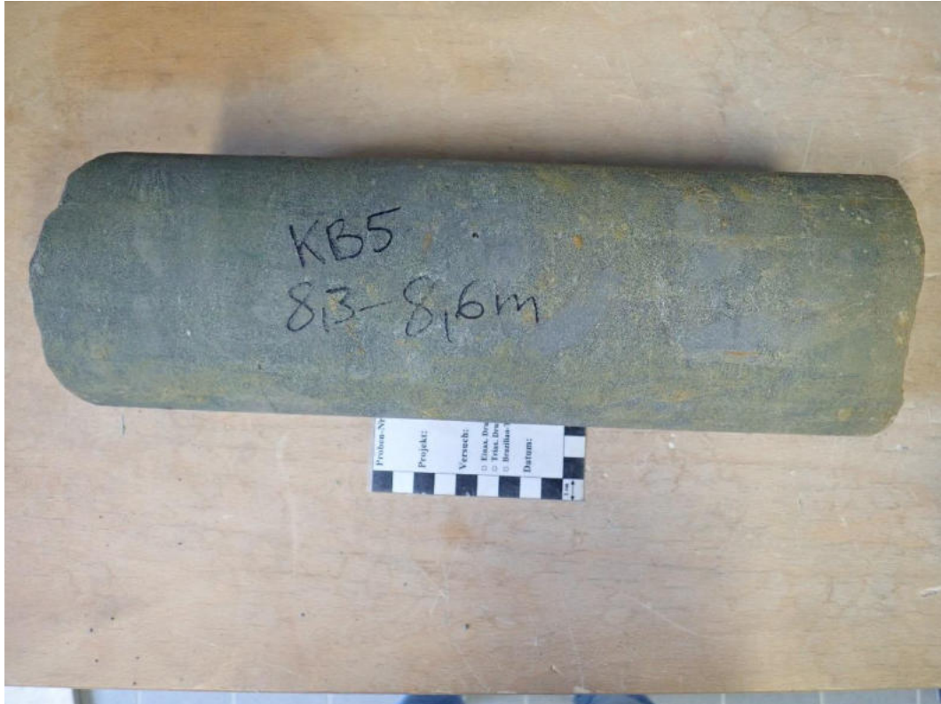
Abbildung 18: Probe KB5 (8,3 – 8,6 m) bei Anlieferung.
