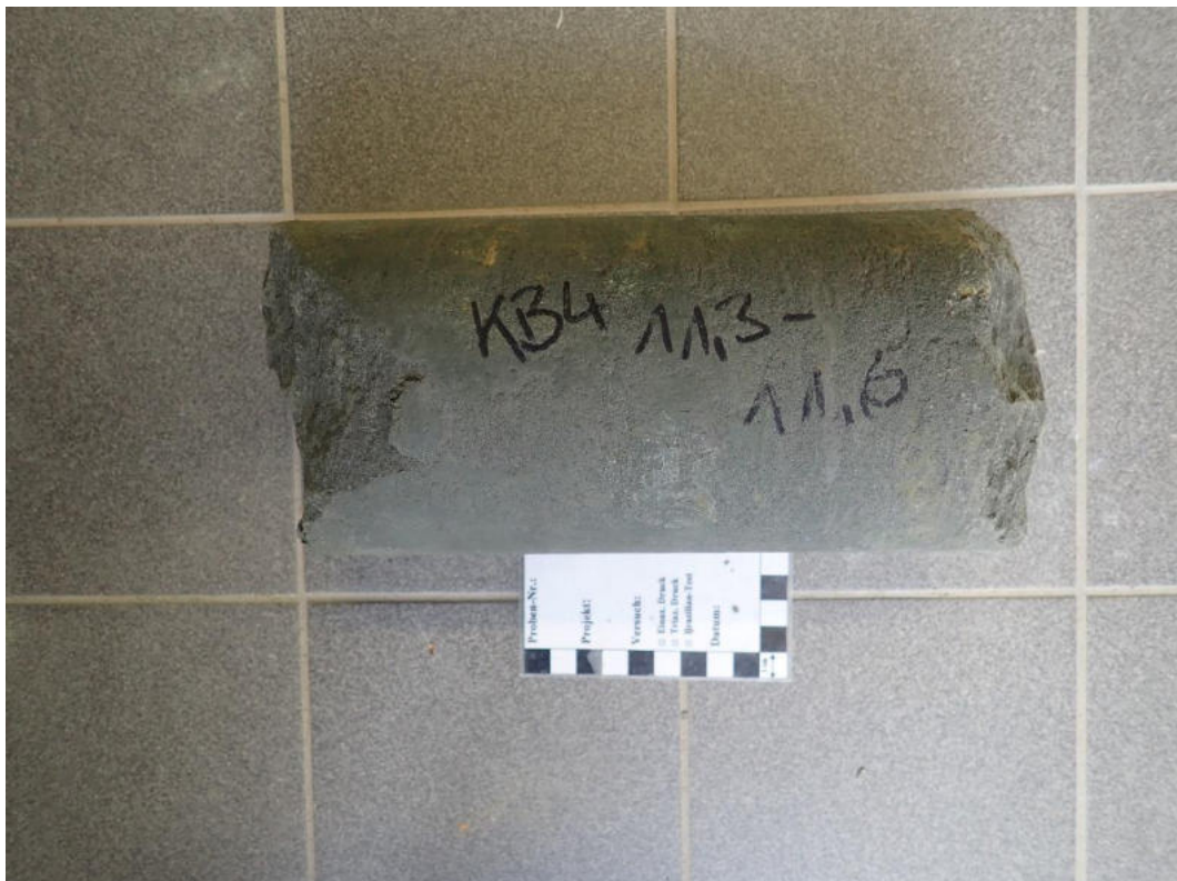
Abbildung 11: Probe KB4 (11,3 – 11,6 m) bei Anlieferung.
