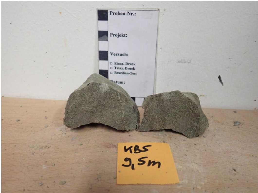
Abbildung 68: Punktlastversuch Probe KB5 (9,5 m): Probe Versuch 4.
