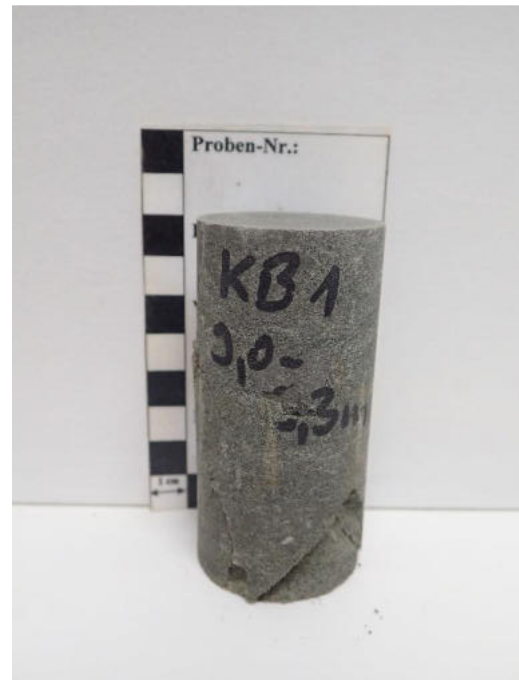
Abbildung 23: Einaxialer Druckversuch Probe KB1 (9,0 – 9,3 m): Spannungs-Dehnungs-Linie, Probe vor dem Versuch, Probe nach dem Versuch.
