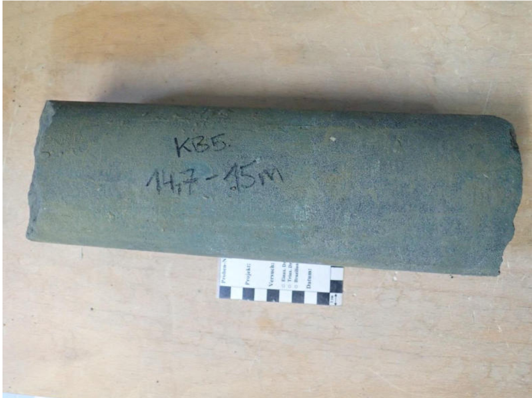
Abbildung 22: Probe KB5 (14,7 – 15,0 m) bei Anlieferung.
