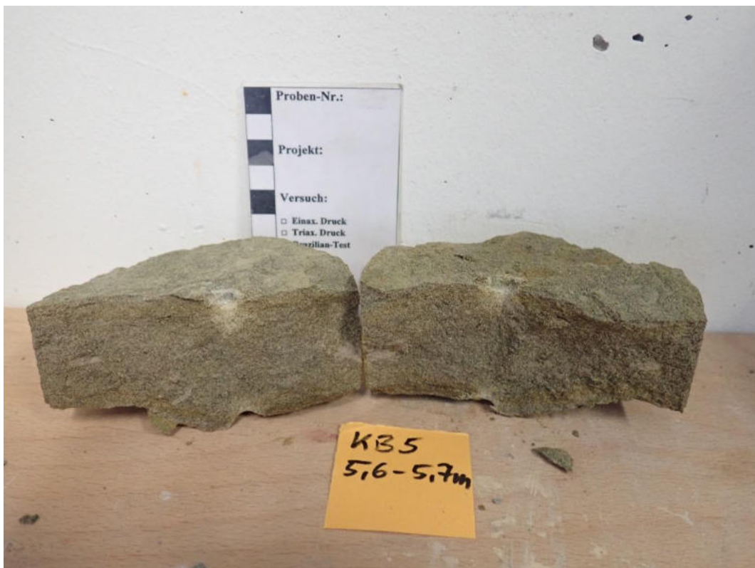
Abbildung 45: Punktlastversuch Probe KB5 (5,6 – 5,7 m): Probe Versuch 1.
