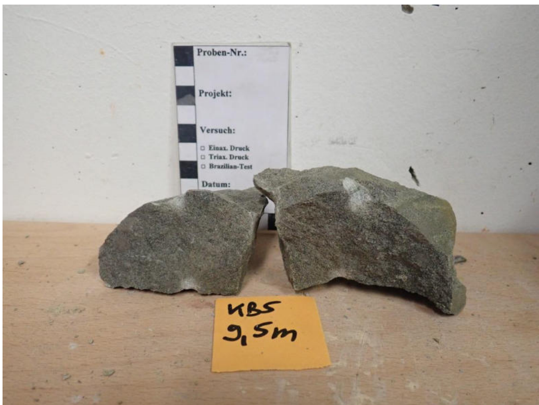
Abbildung 67: Punktlastversuch Probe KB5 (9,5 m): Probe Versuch 3.
