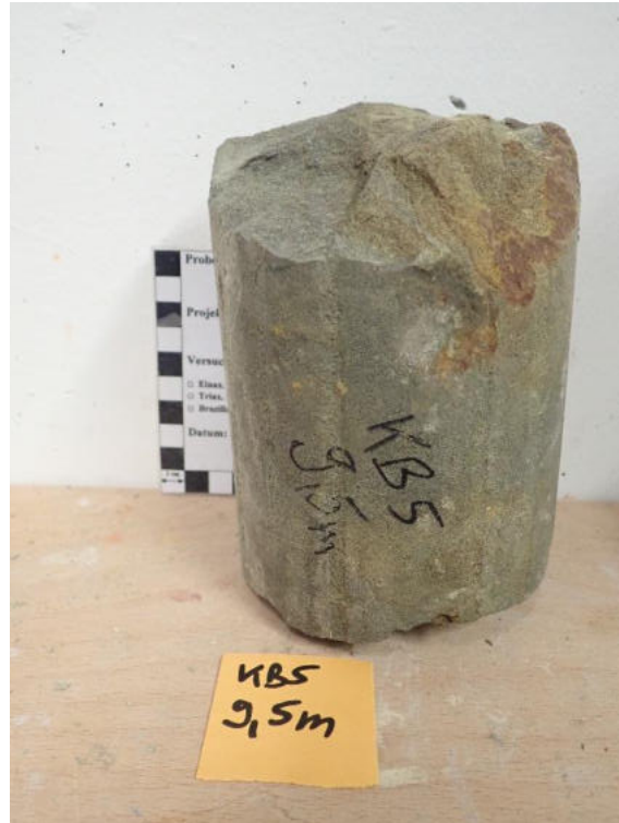
Abbildung 64: Punktlastversuch Probe KB5 (9,5 m): Probe vor dem Versuch.
